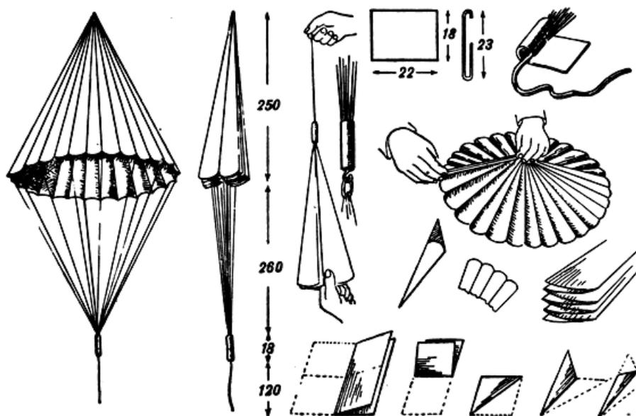
Чтобы изготовить стропы, в доску вбиваем два гвоздя на расстоянии 1500 мм друг от друга и, привязав к одному из них конец катушечной нитки, сделаем четыре витка. Разрежем нитки у гвоздей так, чтобы получились четыре равных отрезка. Согнем из проволоки колечко диаметром 8-10 мм. Сложим стропы пополам и петлей закрепим их середину на кольце. Теперь стало восемь строп одинаковой длины.
