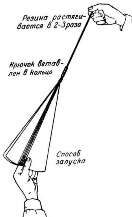
Модель быстро взлетит. В верхней точке полета парашют автоматически раскроется и начнет плавно опускаться вниз.
